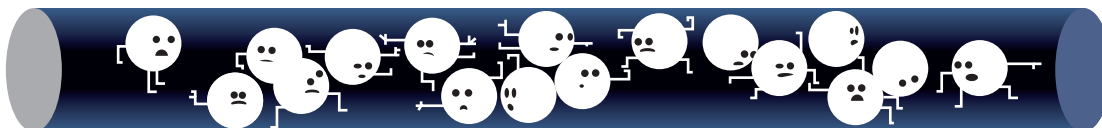
I en vanlig elektrisk ledare knuffas elektronerna med varandra och med materialet.
