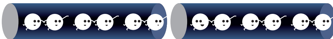
När ett material blir supraleddande kopplar elektronerna ihop sig två och två i Cooperpar , och strömmar då utan motstånd. Luckan i bilden markerar Josephsonövergången.
